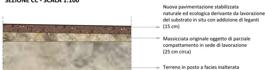
DETTAGLIO STRATIGRAFIA STRADA IN TERRA STABILIZZATA - SCALA 1:20
